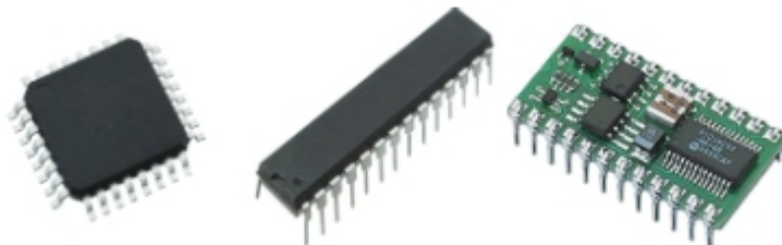
চিত্র ১.৩০: ইন্টিগ্রেটেড সার্কিট ও আইসি বোর্ড এর ভৌত কাঠামো
