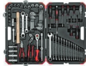
চিত্র -২.৫৩ সকেট বা বক্স রেঞ্জ Socket Wrench
