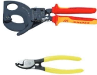
চিত্র-২.৬১ ক্যাবল কাটার Cable Cutter
