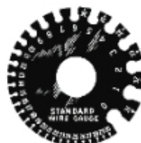
চিত্র -২.৩৫ ওয়্যার গেজ Wire Gauge
