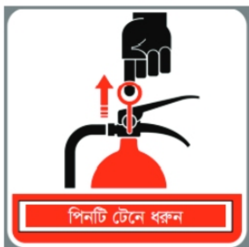
চিত্র ১.২৩ অগ্নিনির্বাপক যন্ত্রের পিন খোলার প্রক্রিয়া
