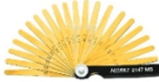
চিত্র-২.৯২ ফিলার গেজ (Feeler gauge)
