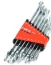
চিত্র -২.৫২ ওপেন ইন্ড স্প্যানার বা ডাল রেঞ্জ সেট Open end Wrench set
