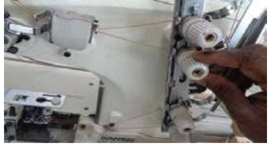
চিত্র : ২.৯ নিডল থ্রেড টেনশন সমন্বয়
