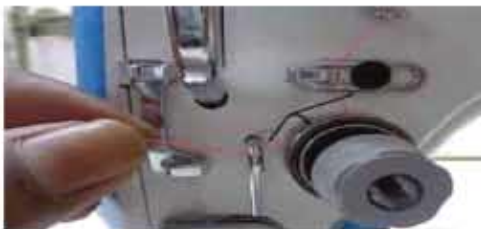
চিত্র : ১.৪৭ ফ্রেম থ্রেড গাইডে সুতা পরানো
