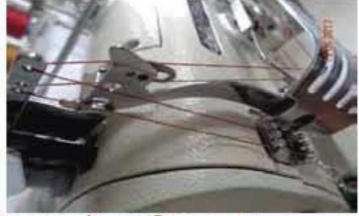
চিত্র : ২.১৬ টেকআপ লিভারে সুতা প্রবেশ করানো
