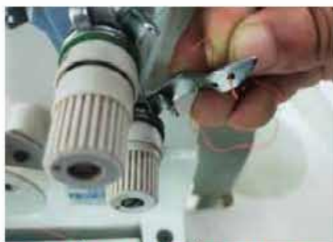
চিত্র : ৪.৫২ টেনশন পোস্ট গাইডে সুতা পরানো
