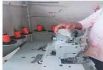
চিত্র: ৪.৪৭ প্রয়োজনীয় যন্ত্রাংশে তেল দেওয়া
