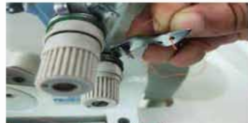
চিত্র : ৪.৭৩ টেনশন পোস্ট গাইডে সূতা পরানো
