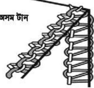
চিত্র : ৩.২৩ উপরের লুপার সুতার অসম টান
