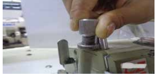
চিত্র : ১.৫৭ প্রেসার ফুটের প্রেসার সমন্বয়করণ
