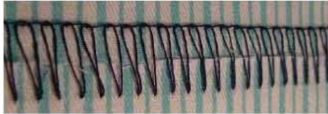
চিত্র : ৩.৫ এক সুতা (সিঙ্গেল থ্রেড) বিশিষ্ট ওভারলক সেলাই
