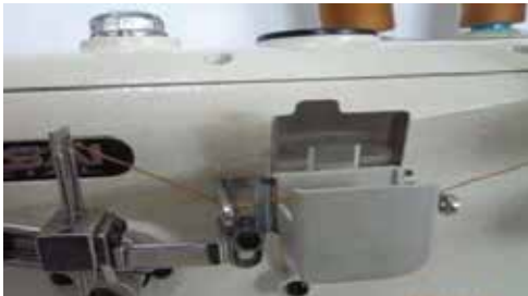
চিত্র : ২.১৫ সুতা থ্রেড পোস্টে প্রবেশ করানো
