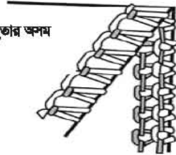
চিত্র : ৩.২৪ নিচের লুপার সুতার অসম টান
