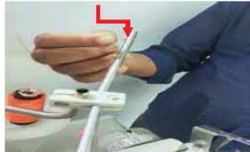
চিত্র : ৪.৬১ থ্রেড গাইড বারে সুতা পরানো
