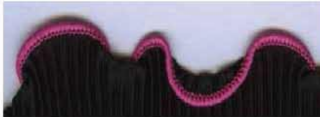
চিত্র : ৩.৫ এক সুতা (সিঙ্গেল থ্রেড) বিশিষ্ট ওভারলক সেলাই
