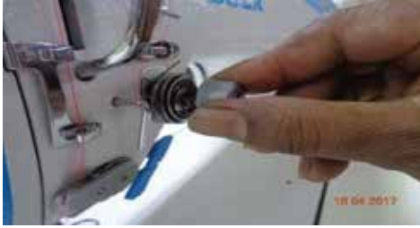
চিত্র : ১.৫৪ নিডেল থ্রেডের টেনশন সমন্বয়
