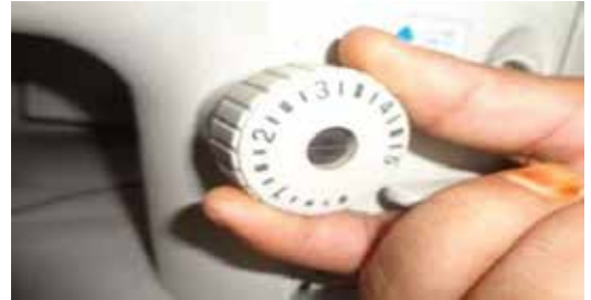
চিত্র : ২.১১ স্টিচ পার ইঞ্চি সমন্বয়
