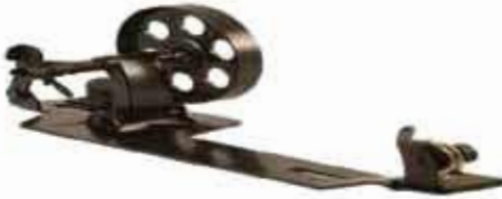
চিত্র : ১.১৭ ববিন উইন্ডার (বেস্টের সাথে)
