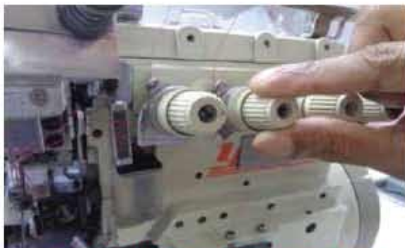
চিত্র : ৩.২৫ নিডল শ্রেড টেনশন পোস্ট সমন্বয়
