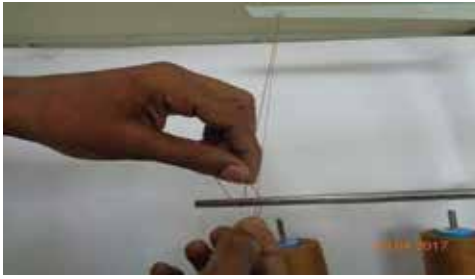
চিত্র : ২.১৩ সুতা থ্রেড পোস্টে প্রবেশ করানো
