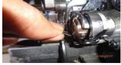
চিত্র : ১.৫৮ ববিনের সুতার টেনশন সমন্বয়
