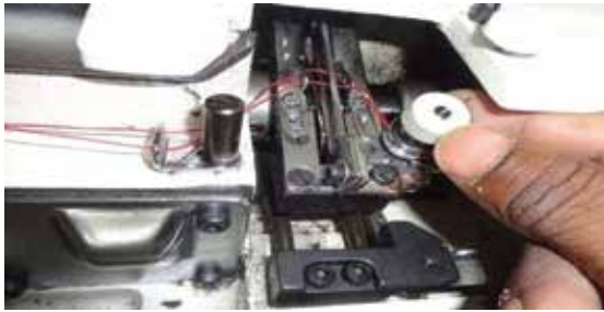
চিত্র : ২.১০ লুপার থ্রেড টেনশন সমন্বয়
