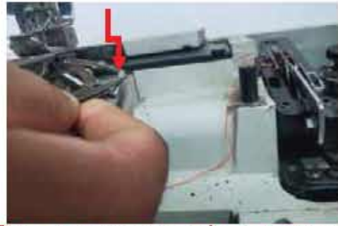
চিত্র : ৪.৬৭ লুপারের প্রথম আই - এ সূতা পরানো
