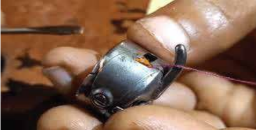
চিত্র : ১.৫৮ ববিনের সুতার টেনশন সমন্বয়
