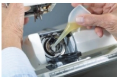
চিত্র- ৩.৭৪ সিঙ্গেল নিডেল লকস্টিচ মেশিনে তেল দেয়ার চিত্র।
