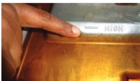
চিত্র- ৩.৭৪ সিঙ্গেল নিডেল লকস্টিচ মেশিনে তেল দেয়ার চিত্র।
