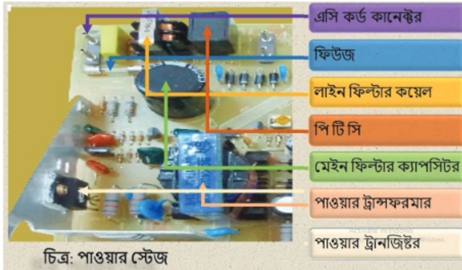
চিত্র-১.১০ পাওয়ার সেকশন এর কম্পোনেন্ট
