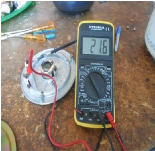
চিত্র- একটি রাইস কুকারের হিটিং ইলিমেন্ট পরীক্ষাকরণ
