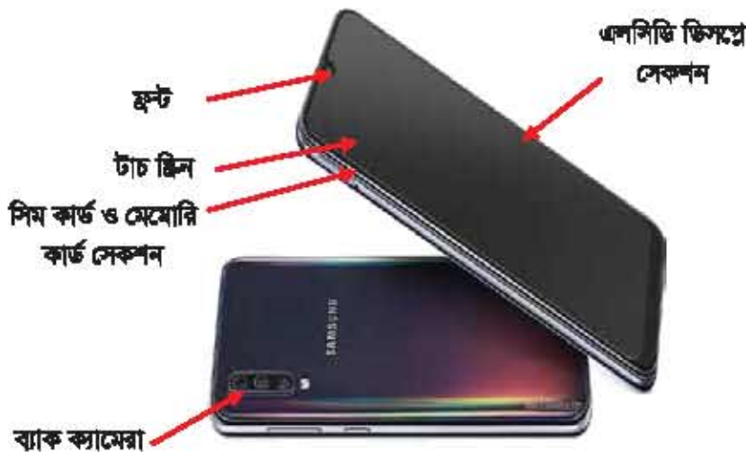
চিত্র-৪.১ স্মার্ট মোবাইল ফোনের বিভিন্ন সেকশন (Mobile Phone Model: Samsung Galaxy A50)
