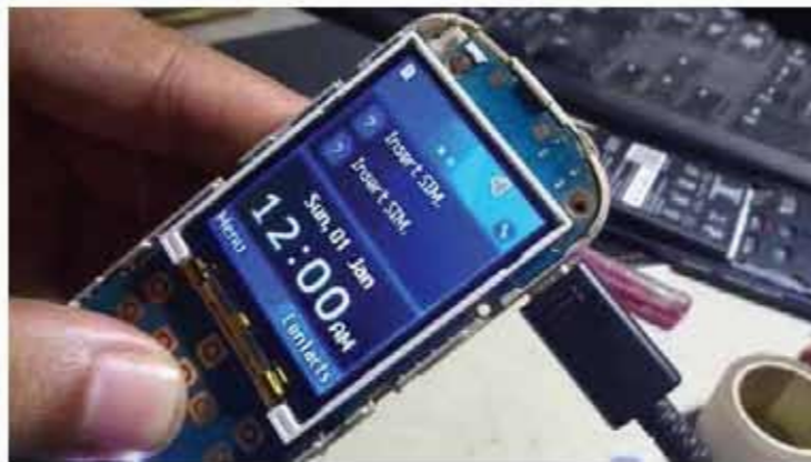
চিত্র- চার্জার সংযুক্ত করে চার্জিং এর সমস্যা শনাক্ত করণ
