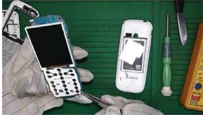
চিত্র- কিপ্যাড এর সার্কিট বোর্ড পৃথককরণ
