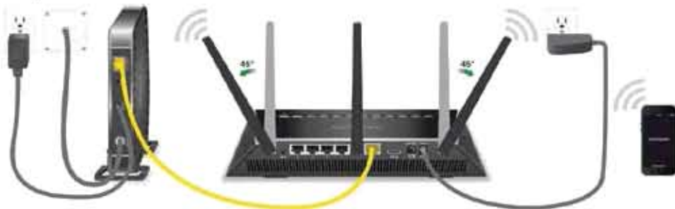
চিত্র-২.৪ রাউটারে ব্রডব্যান্ড কানেকশন, পাসওয়ার্ড অ্যাডাপ্টার কানেকশন এবং কম্পিউটার কানেকশন করণের দৃশ্য
