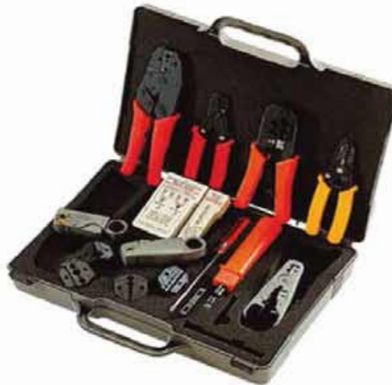
চিত্র-১.৩১ কেবুল টিভিতে ব্যবহৃত কো-অক্সিয়াল ক্যাবল ইনস্টলেশন কিট
