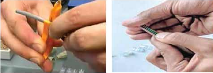
চিত্র-১.৪১ কালার কন্ডিশনেশন অনুযায়ী ইউটিপি কেবলের এক প্রান্ত ওয়্যার খিঁপার দিয়ে ঊপরের পাঁচলা আবরণটি ফুলে ফেলা ও ভিতরের চিকন তারগুলো সাজানোর দৃশ্য
