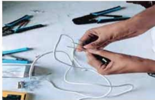
চিত্র-ভেতরের চিকন তারগুলোর পঁচাচ খুলে সোজা করার দৃশ্য
