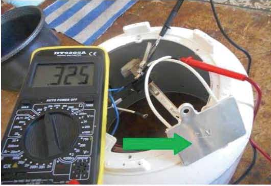
চিত্র- একটি রাইস কুকারের হাই রেজিস্ট্যান্স অসিলেশন সার্কিট পরীক্ষাকরণ
