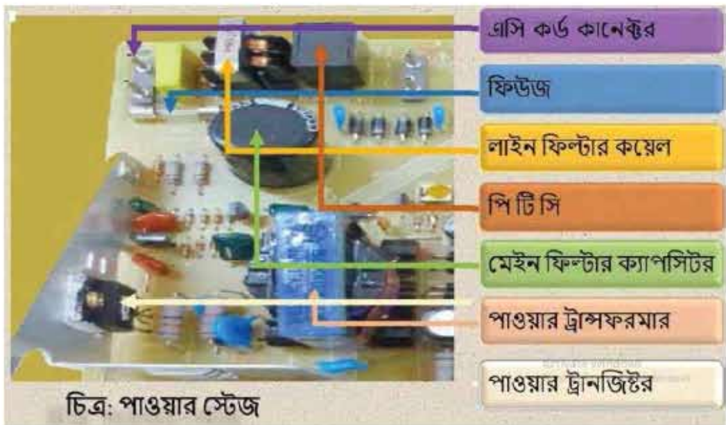
চিত্র-২.৩ কালার টিভি রিসিভারের পাওয়ার সেকশন
