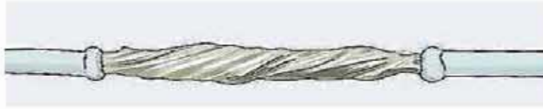
চিত্র: ৪.১৪ তারের সোল্ডারিং বা খালাই
