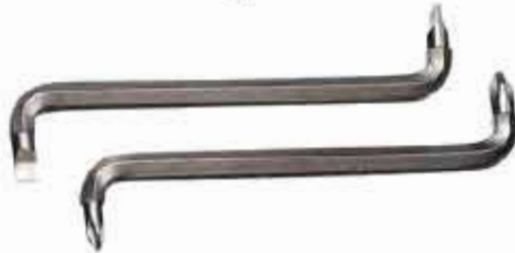
চিত্র -২.২৮ অফসেট স্ক্রু ড্রাইভার Offset Screw Driver
