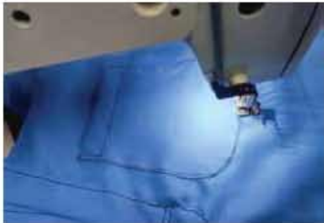
চিত্র: ২.২৩ ফ্রন্ট পার্টে পকেট অ্যাটাচকরণ
