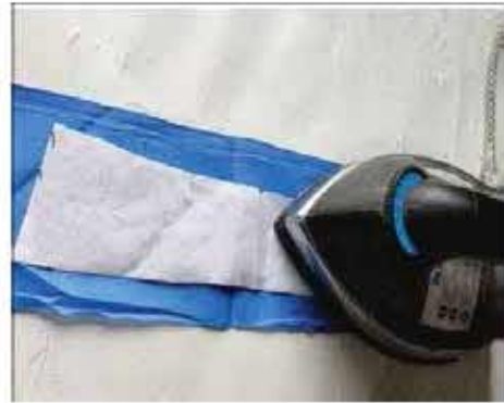
চিত্র-৪.৩৬ কলারের টপ পার্ট ফিউজিং
