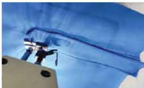
চিত্র-৪.৬৭ এটাচ আপার প্রাকেট
