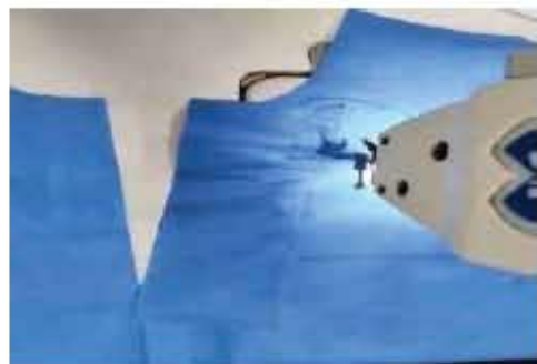
চিত্র: ২.২০ ফ্রন্ট পার্টে আপার প্রাকেট সংযুক্তিকরণ
