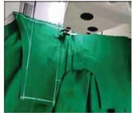
চিত্র: ১.২৫ ফ্রন্ট টপ এবং বটম জয়েন্টকরণ
