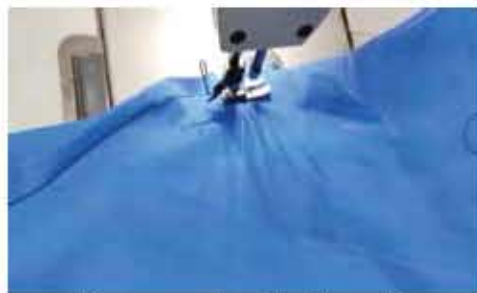
চিত্র-৪.৬৯ এটাচ প্রিভ উইথ বডি
