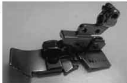
চিত্র -৩.২৯ ট্রান্স্ভার প্রেসার ফুট
