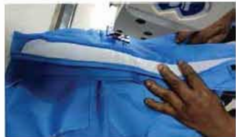
চিত্র-৪.৭২ কলার এটাচ উইথ বডি
