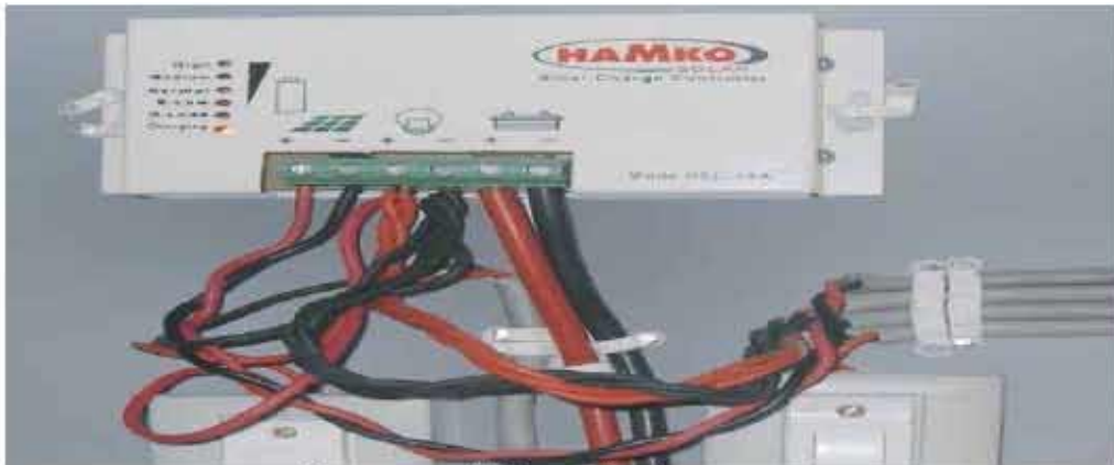
চিত্র- ৩.২২ ব্যাটারি ও চার্জ কন্ট্রোলার সংযোগ
