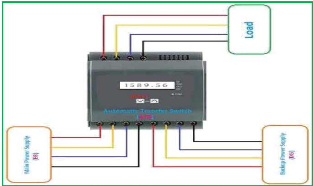
চিত্র- ১.৯ চেস ওভার সুইচ এর কনেকশন ডায়াগ্রাম
