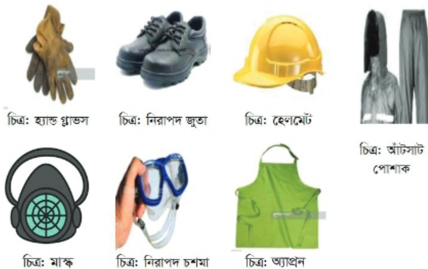
চিত্র ১.১: নির্মাণ কাজে ব্যবহৃত ব্যক্তিগত নিরাপত্তা সামগ্রী
