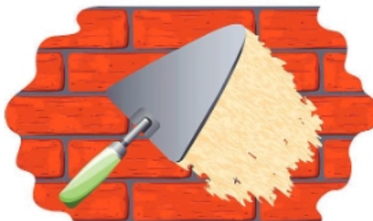
চিত্র ৪.১০: প্লাস্টারিং কাজে কুর্পির ব্যবহার
